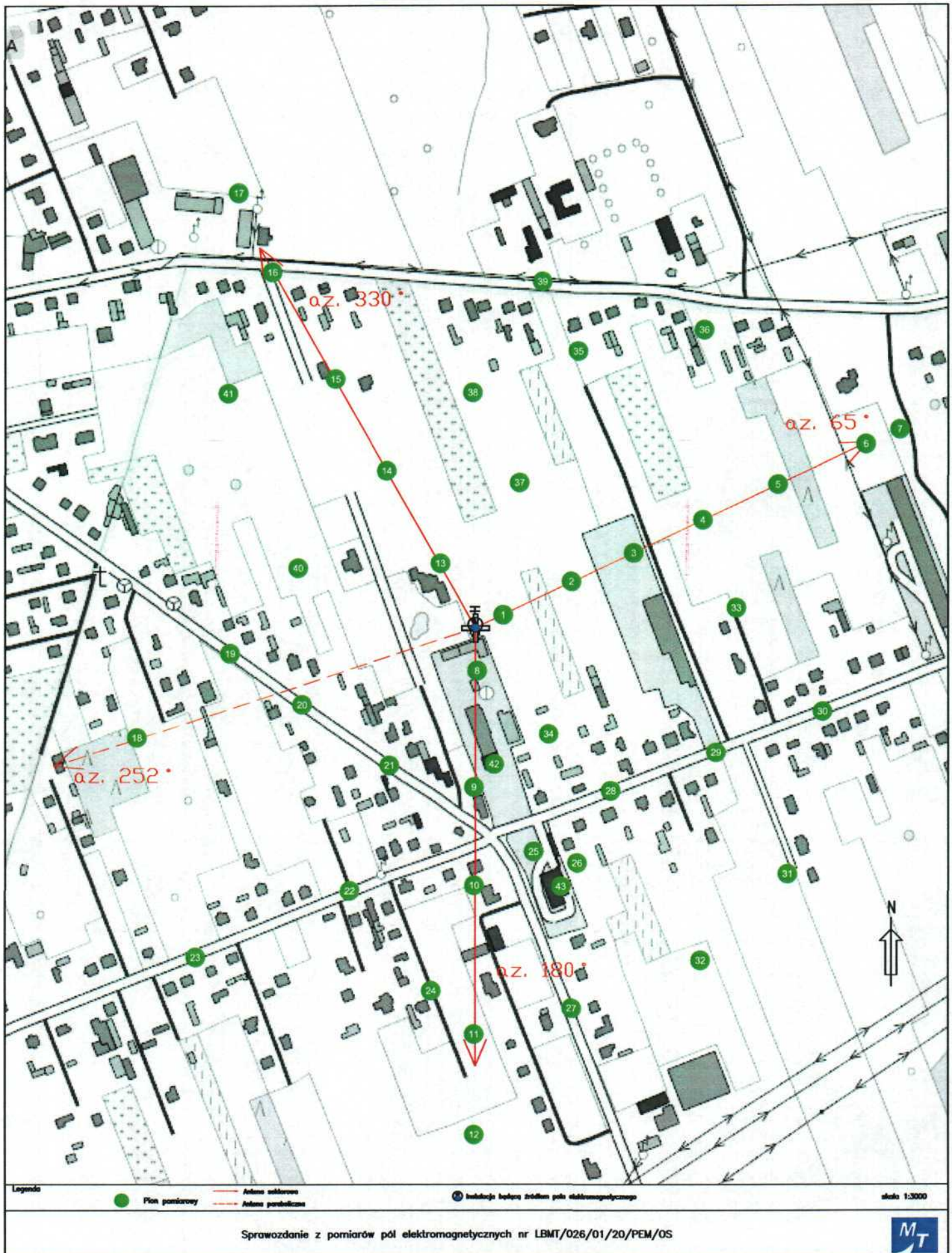
Rys.1 Lokalizacja pionów pomiarowych
