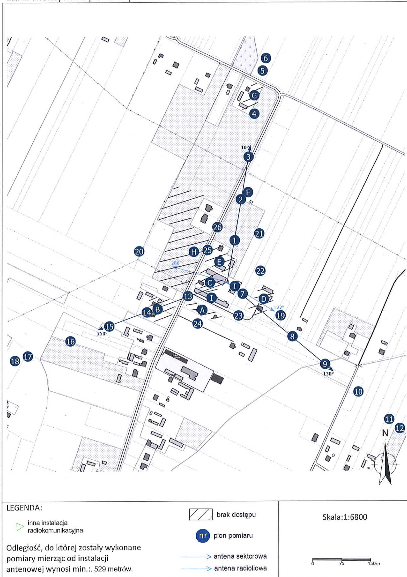
Załącznik 2. Widok pionów pomiarowych
