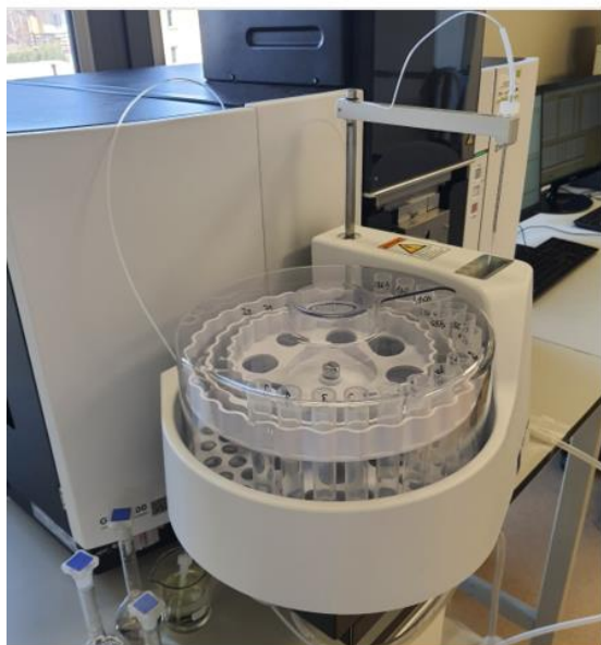
Zdjęcie nr 3. Oznaczanie metali w wodzie metodą absorpcyjnej spektrometrii atomowej przy użyciu spektrometru absorpcji atomowej SHIMADZU AA-7800 (źródło: zasoby własne PSSE)
