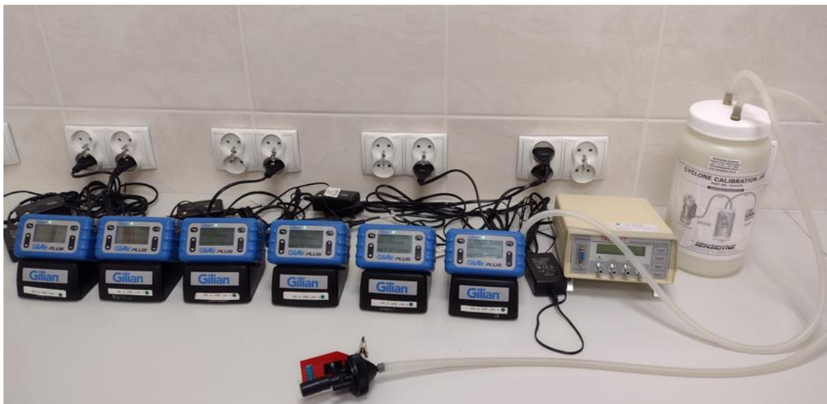
Zdjęcie nr 4. Aspiratory do pobierania próbek pyłowych zanieczyszczeń powietrza na stanowiskach pracy (źródło: zasoby własne PSSE)
