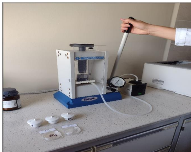
Zdjęcie nr 4. Prasa hydrauliczna do przygotowania próbek do oznaczania krystalicznej krzemionki (źródło: zasoby własne PSSE)
