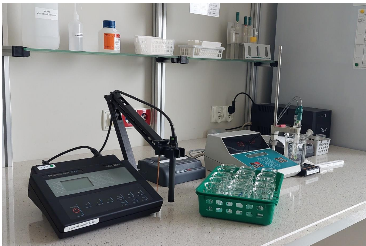
Zdjęcie nr 1. Aparatura do badań pH i przewodności wody (źródło: zasoby własne PSSE)
